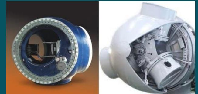
Cubo do rotor e subcomponentes - solarpedia.com
